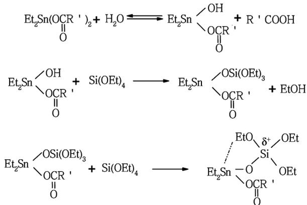
图3 二月桂酸二丁基锡与正硅酸乙酯的反应
