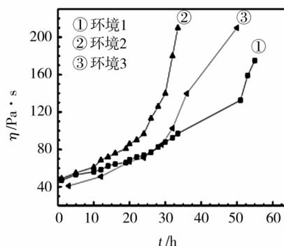
图1 温湿度对低密度材料树脂基体黏度的影响
