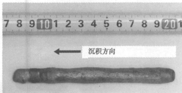
图 1 激光熔化成沉积钛基复合材料棒状试样
