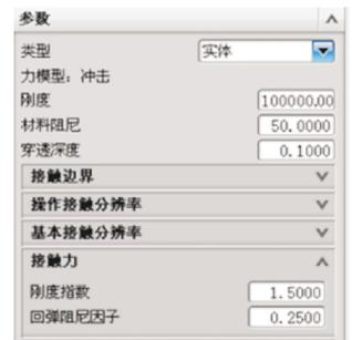
图 4 碰撞参数的设定
