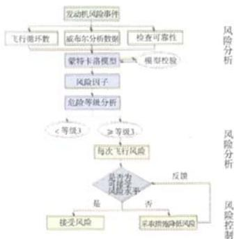
图1 航空发动机故障风险管理流程
