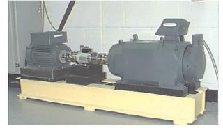
图1 滚动轴承注入式故障试验台
