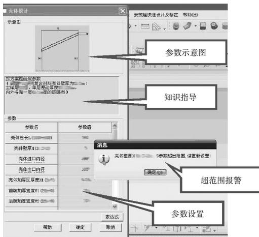
图6 壳体快速设计参数设置界面
