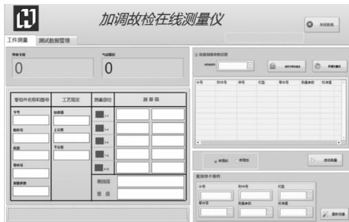
图6 加力调节器故障检测在线测试系统软件界面
