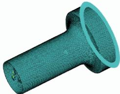
图 4 转子 - 支承 - 机匣系统的有限元模型
