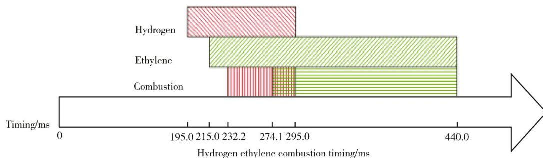
图7 第2油位单点注油试验时序
