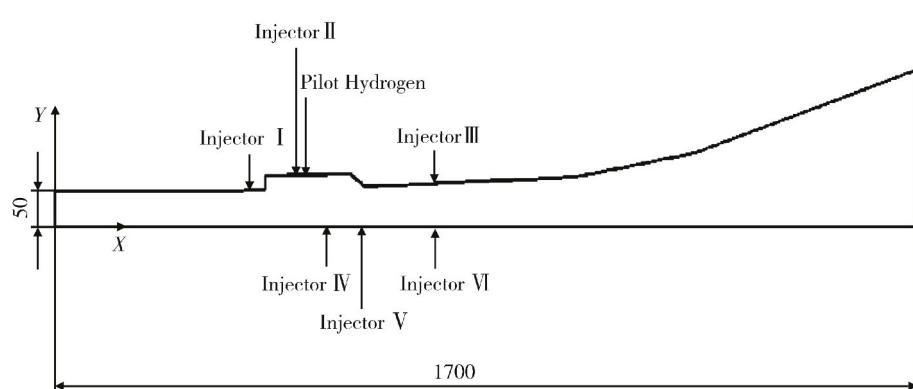
图 3 超燃冲压发动机模型(单位:mm)
