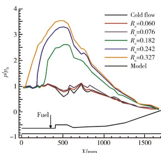
图 6 第 1 油位注油时不同当量比的壁面压力分布
