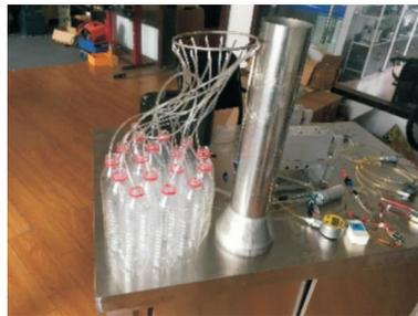
图2 喷油环流量测试实验
