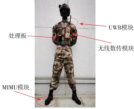
图1 单兵协同导航系统硬件配置示意图
