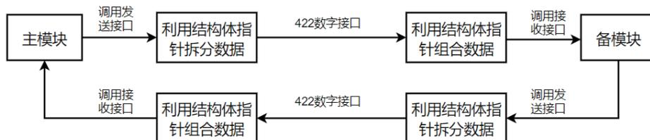
图 4 主备模块数据同步设计流程图
