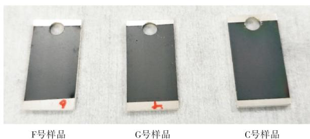
图 1 碳/钛掺杂碳基纳米薄膜实物样片
