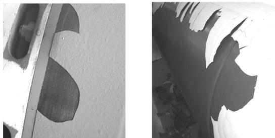
图1 RT-III涂料在产品上的裂纹、开裂及脱落现象
