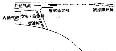
图 4 SEDRI 的涡轮后框架燃烧室方案
