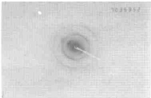
图 4 插层碳纤维的选区电子衍射图
