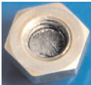
图 1 故障螺栓断口宏观形貌
