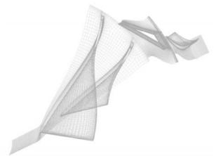
图 4 离心压气机单通道网格
