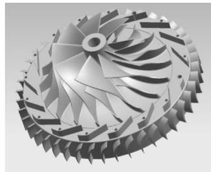
图 1 离心压气机 3 维模型
