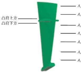
图8 叶片厚度测量截面
