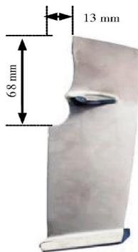
图1 掉块故障叶片宏观形貌(叶盆侧)
