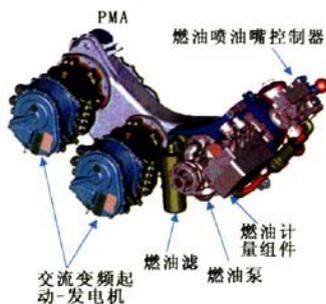
图 18 装有 2 台交流变频启动-发电机的附件机匣
