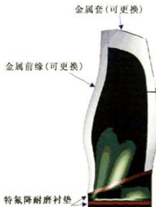
图 9 复合材料风扇叶片
