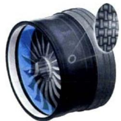
图 11 复合材料风扇机匣
