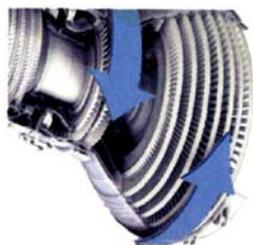
图 16 GENx 发动机反转的高、低压转子
