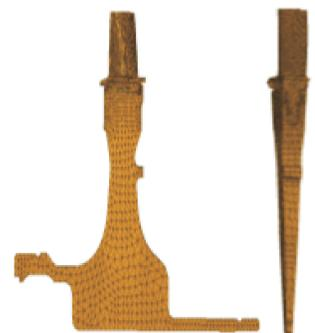
图 10 涡轮叶/盘转子结构有限元模型
