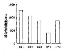
(d) 图 6 复合材料的力学性能
