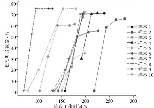
图 2 叶片掉冠发动机松动叶片数量随阶段工作时间的变化关系<sup>[3]</sup>
