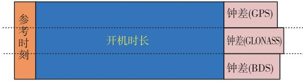
图 1 GNSS 接收机时间模型示意图
