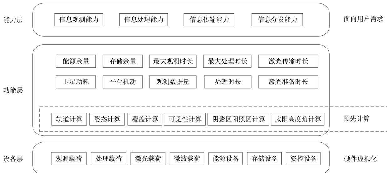
图 3 天基资源虚拟化层次结构图
