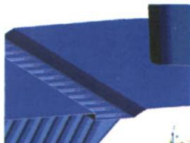
图2 带槽气膜孔2
