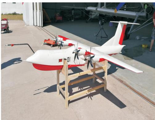
图 1 某大型四发螺旋桨飞机自由飞模型
