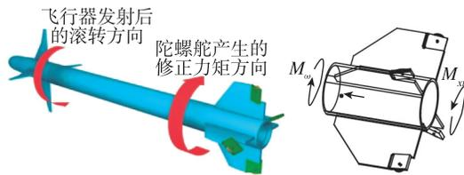
图2 陀螺舵工作原理图
